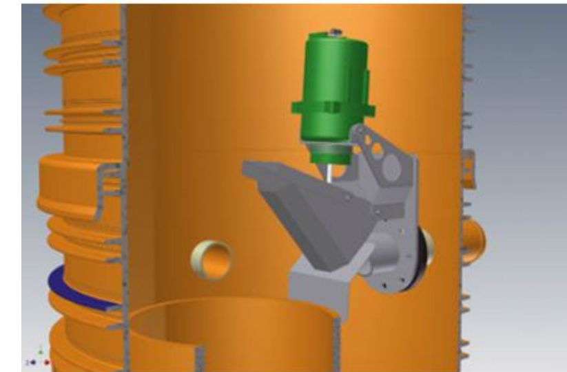
Abbildung 7.1 (oben) und 7.2 (unten): Konstruktion der Variante Kippschütte Modell: Schäfer, Synantik GmbH - Industrielle Mess- und Regelungstechnik
