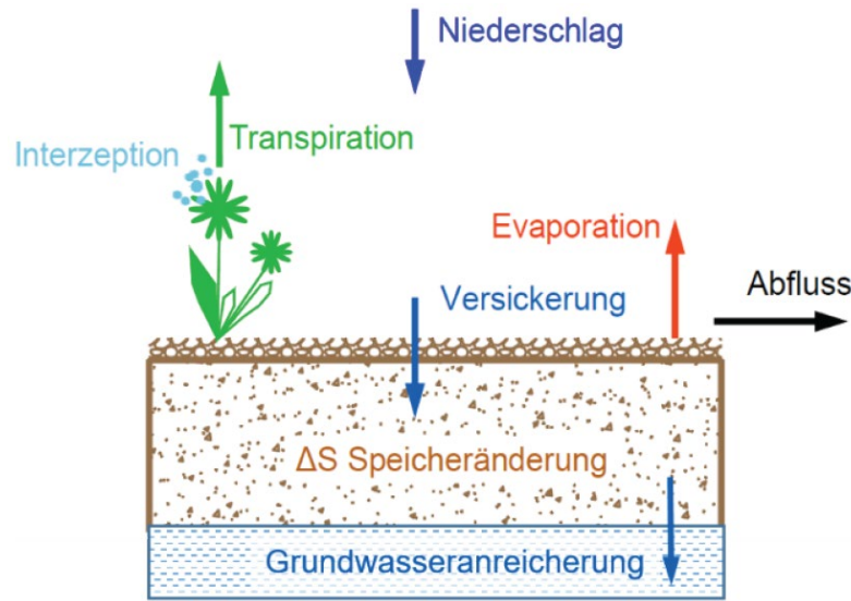
Schematische Darstellung der Wasserbilanzkomponenten; Leitfaden Regenwasserbewirtschaftung (Projekt Flexadapt), 2019, BMNT
